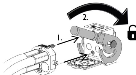
La leva deve potersi muovere facilmente fino alla posizione di bloccaggio. Se la leva non scorre in modo fluido, controllare l'allineamento e la posizione del connettore e pulire i connettori. Spegnerne anche la pala cariatrice e rilasciare la pressione idraulica residua.
